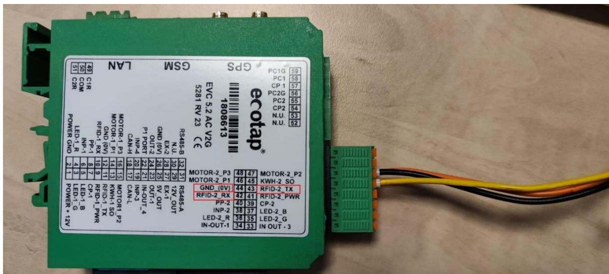
Figure 5.5 - Connexion du câble USB à TTL au contrôleur (EVC 5.x).
