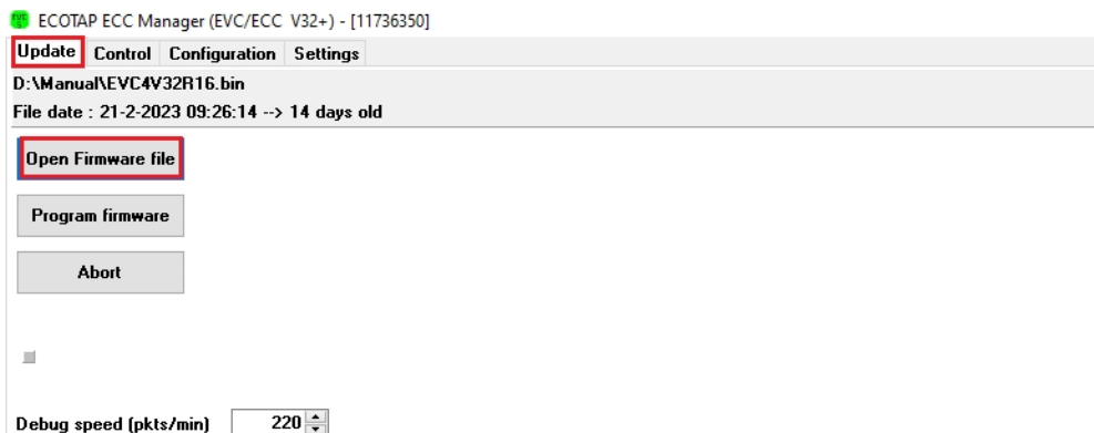
Figure 7.1 - Ouvrir le fichier firmware (l'image provient du programme lourd mais est identique sur la version portable 'ECCLite').
